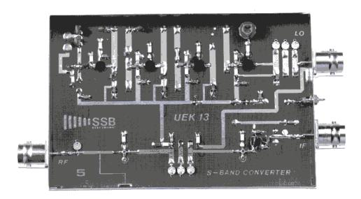
Bei der Entwicklung dieses Konverters standen die Forderungen nach guten technischen Daten und kompakten Abmessungen im Vordergrund. Zur Erzielung einer günstigen Rauschzahl und guter Selektion wurde für den Aufbau eine Teflon-Platine gewählt. Die für einen kompletten 13-cm Konverter geringen Abmessungen wurden durch den Einsatz der SMD-Technik verwirklicht.
